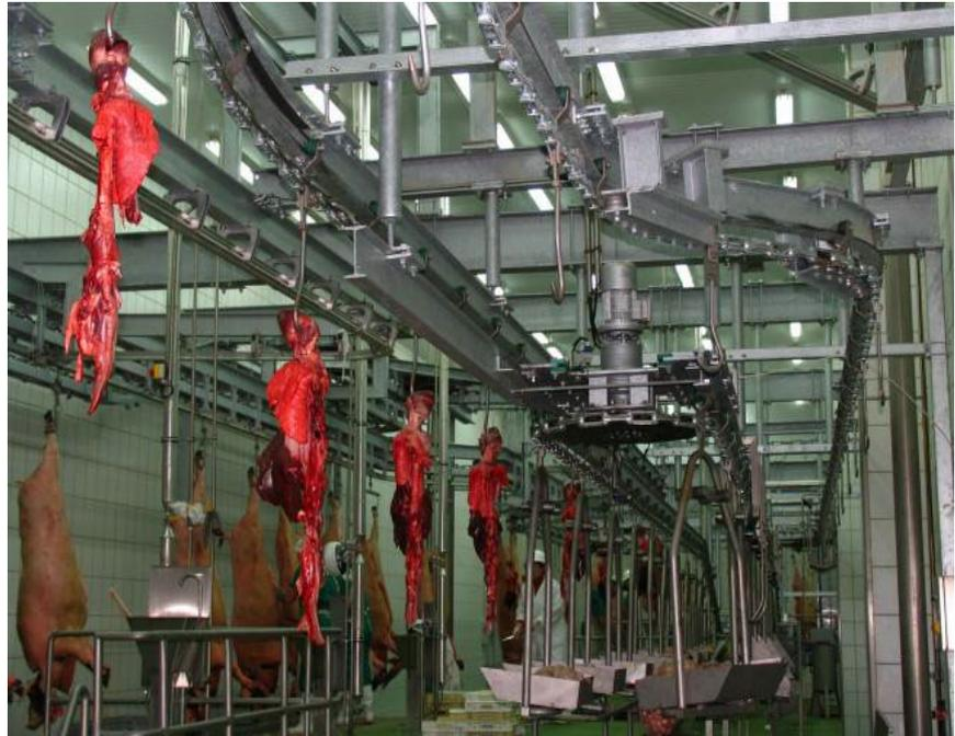
Bandejas y ganchos para el transporte de vísceras blancas y rojas en acero inoxidable AISI-304, con acabado granallado. Distintos diseños según instalación.
